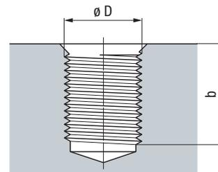
**CNC-Innengewindefräsen (im Gegenlauf, an der Kontur, inkremental, nach DIN 66025)**
