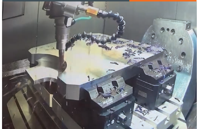
Mehrfachspannung von Großbauteilen Multiple clamping of large components
